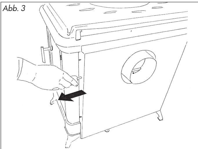
Der Primärluftregler muss nun auf die zur Aufrechterhaltung der gewünschten Raumtemperatur notwendige Stellung zurückgedreht werden. Das Gerät darf, außer beim Gluthalten, nicht auf Reglerstellung „min“ betrieben werden.
