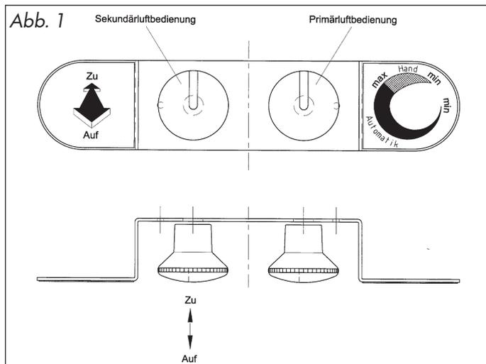
Der Herd Winston ist mit einem Automatik-Leistungsregler (Abb. 1) ausgerüstet, der die für die Verbrennung notwendige Primärluft regelt. Dieser ist stufenlos einstellbar.
