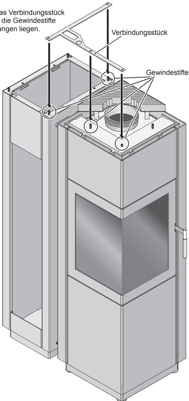
Der Abstandhalter des Sockels gewährleistet den geforderten Mindestabstand zwischen Ofen und Holzablage. Gezeigt ist hier die Montage der Holzablage auf der linken Seite. Für die Montage der Holzablage auf der rechten Seite, ist der Sockel abzuschrauben und um 180° gedreht wieder anzuschrauben.
