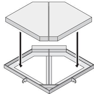
**2.** Den Rahmen mit den eingelegten Filtern auf die mittlere hintere Feuerraumwand legen.
