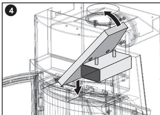
Schwenken Sie die obere Heizgasumlenkplatte seitlich herunter und entnehmen sie
