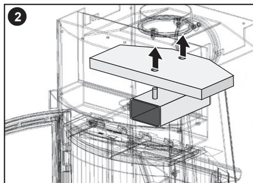
Die Bolzen des Luftkanals greifen in die Bohrungen der oberen Heizgasumlenkplatte.
