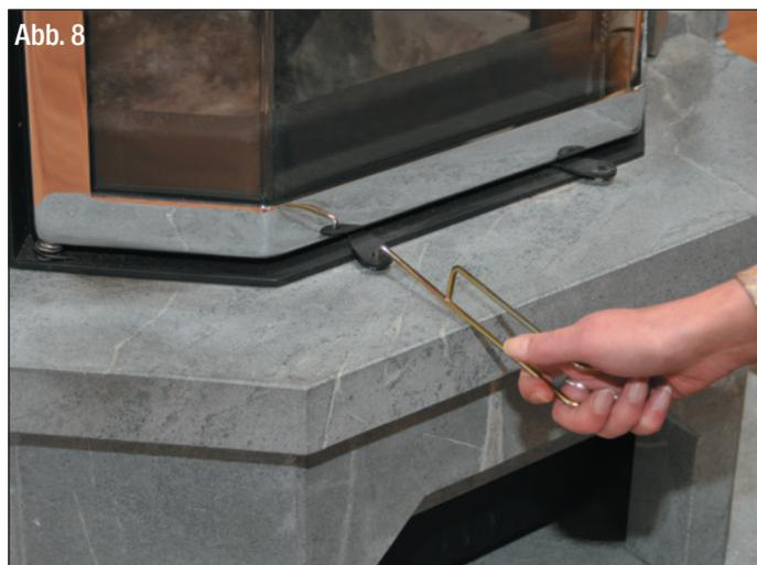
haben. Jetzt können Sie die Primärluft-Einstelleinrichtung (links) auf "ZU" stellen (Abb. 8) und die Verbrennung hauptsächlich über die Sekundärluft-Einstelleinrichtung (rechts) regeln.
