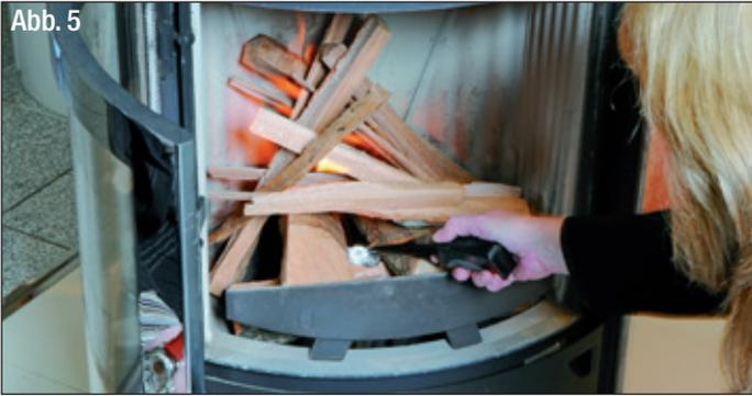
Lassen Sie diese Holzaufgabe mit auf "AUF" stehender Primär- und Sekundärluft herunterbrennen, bis kaum noch Flammen vorhanden sind und das Holz in die Glutphase übergeht (Abb. 6). Je nach Holzgüte, Schornsteinzug und Witterung dauert diese Verbrennungsphase unterschiedlich lange.
