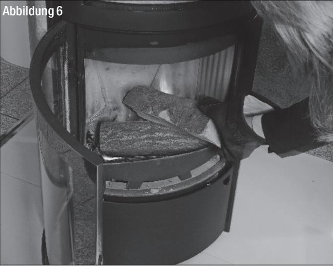
Die hier benannte Menge an Anzündholz und der Zeitpunkt der Reduzierung der Verbrennungsluft (Verbrennungsluftregler ganz bzw. teilweise schließen) können nur Anhaltswerte darstellen. Die optimale Menge bzw. die besten Reglereinstellungen hängen ganz erheblich von Art und
