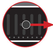
Verbrennungsluft- schieber zu
