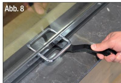
Sind auch diese Holzsplitte rundherum angebrannt, sollten Feuerstätte und Abgassystem weitgehend die Betriebstemperatur erreicht haben. Jetzt können Sie die Verbrennung über die Primärluft-Einstelleinrichtung regeln. (Abb. 8)
