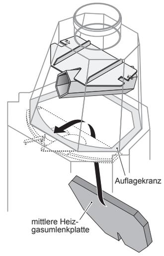
**2** Die mittlere Heizgasumlenkplatte auf den hinteren Teil des Auflagekranzes auflegen
