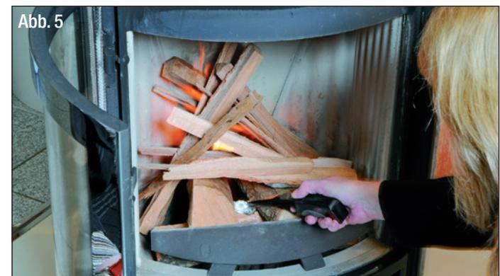
Lassen Sie diese Holzaufgabe mit auf "AUF" stehender Primär- und Sekundärluft herunterbrennen, bis kaum noch Flammen vorhanden sind und das Holz in die Glutphase übergeht (Abb. 6). Je nach Holzgüte, Schornsteinzug und Witterung dauert diese Verbrennungsphase unterschiedlich lange.
